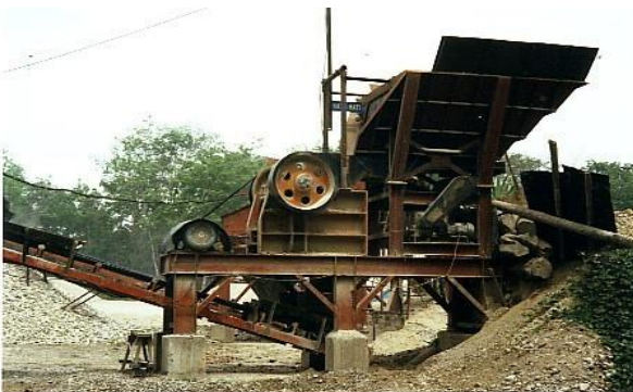
Gambar 2.5. Jaw Crusher Dalam Operasi
